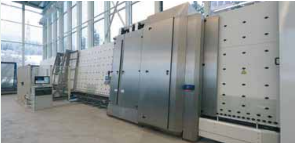
Waschanlage, Produktionshalle Isolierglas, St. Gallen-Winkeln
