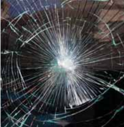
Bruchbild SWISSLAMER VSG: Splitterbindende Eigenschaft durch PVB-Folie
